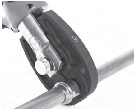
Figure 9 – Positionnement des mâchoires autour du raccord
