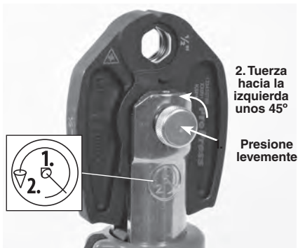
Figura 7 – Apertura del pasador de montaje de accesorios
