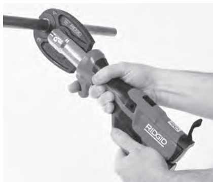
Figura 11 – Selladura del acoplamiento
